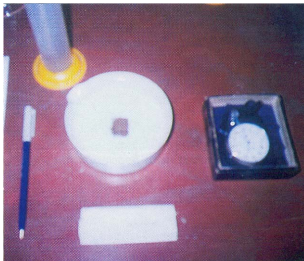
Figura 1. Ensayo de Crumb
