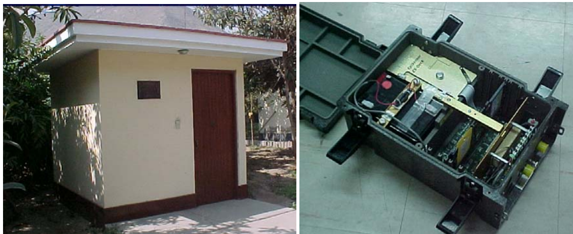
Figura 3. Estación Acelerográfica del CISMID y acelerógrafo instalado.
